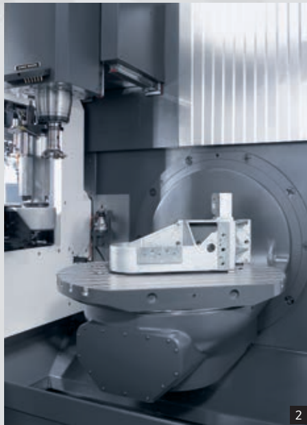
1: 高度灵活的 3 轴至 5 轴加工 2: 选配刀库后高清晰度的加工区视野 3: 联动工作台
